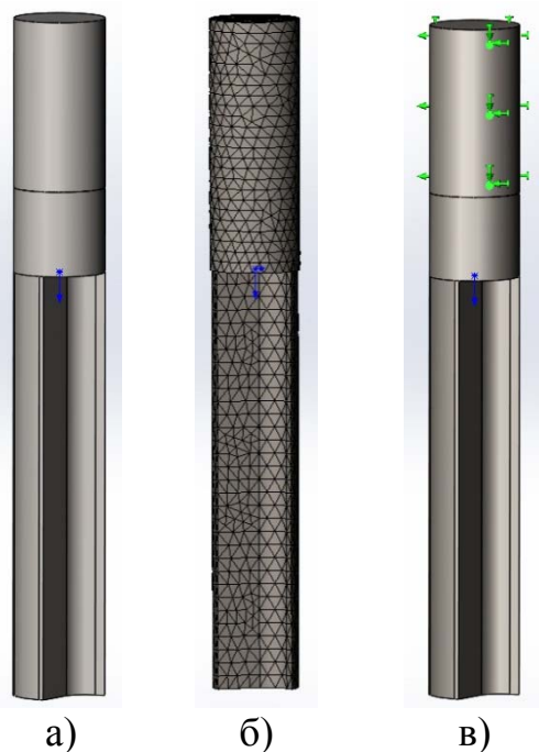
Рисунок 5 Общий вид модели (а), сетка разбиения на конечные элементы (б) и вид закрепления модели (в)
